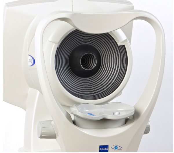
Şekil 2.1: Placido halka sistemini kullanan Zeiss Atlas 9000 Korneal topografi sistemi
