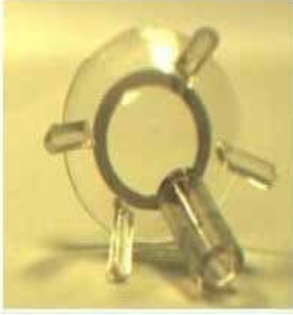
Resim 2. Kapakların açık kalması için tasarlanmış blefarostanın üzerine yerleştigi tek kullanımlık korneaya temas eden elektrotlar
