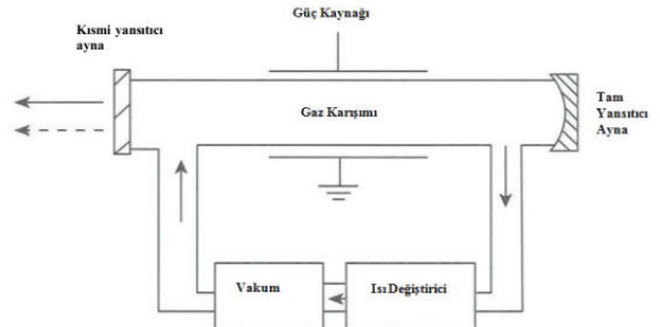
Şekil 2: Gaz lazer sisteminin şematik gösterimi
