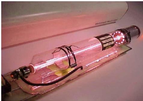
Şekil 3: Bir Helyum-Neon lazeri (sol) ve lazerin şematik çizimi (sağ)
